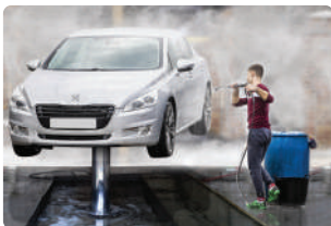
Gambar 3.9 Pompa hidrolik pengangkat mobil.
