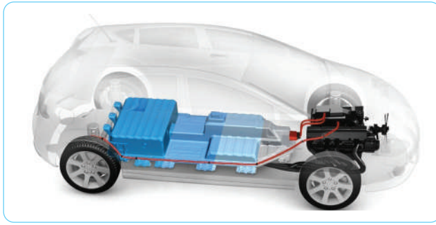
Gambar 4.13 Baterai pada mobil listrik.
