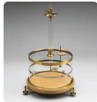
Gambar 4.3 Eksperimen percobaan Coulomb untuk menentukan muatan listrik.
