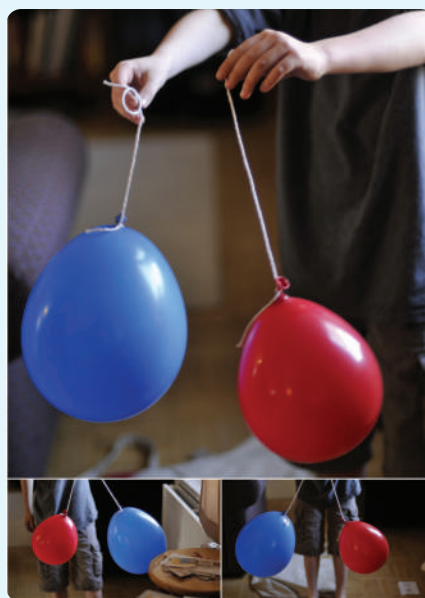
Gambar 4.4 Percobaan menentukan gaya listrik pada dua balon yang bermuatan.
