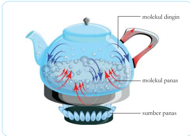
Gambar 6.13 Arus konveksi dalam cairan yang dipanaskan.
