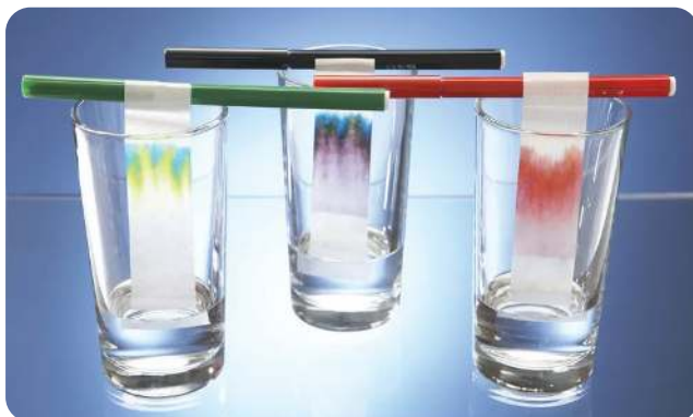
Gambar 5.30 Contoh hasil kromatografi pada tinta warna warni
