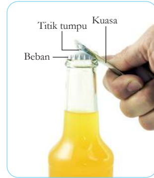
Gambar 3.15 Alat pembuka botol, contoh pengungkit jenis 2
