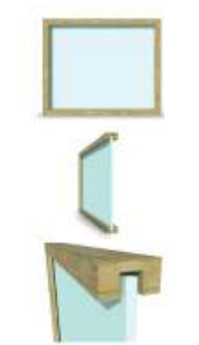
Gambar 3.16 Dudukan jendela dibuat lebar, untukantisipasi pemuaian luas.
